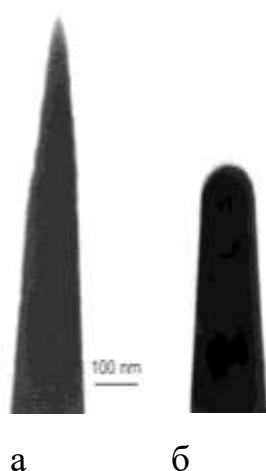
Рис. 2.3. Типові тіньові електронно-мікроскопічні мікрофотографії вістрійного зразка, який було виготовлено електрохімічним травленням перед (а) і після (б) польового випаровування.
