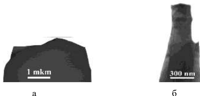
Рис.5.9. Електронно-мікроскопічні фрактограми невісесиметричного вістрійного нанокристалу (а) вольфраму, який зруйнувався при навантаженні 15.5 ГПа та (б) молібдену, який зруйнувався при навантаженні 9.4 ГПа.
