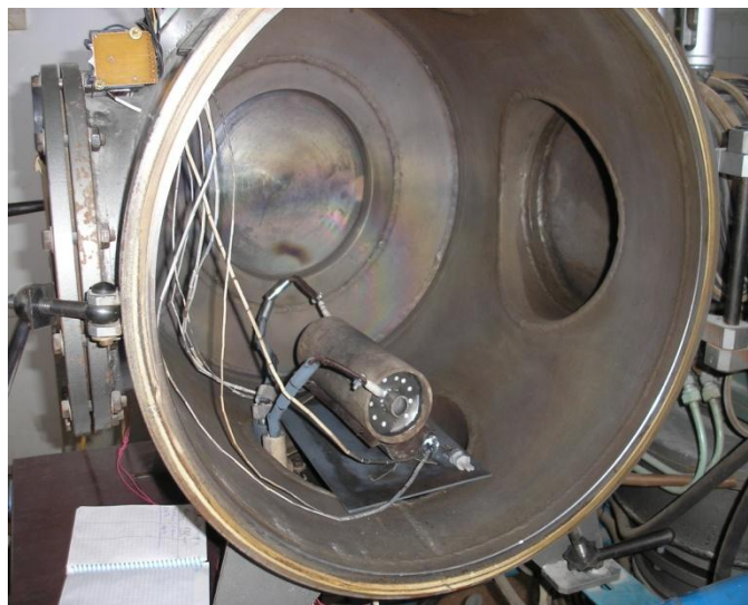
Рис. 2.2. Установка для очищення вихідних порошків від газових домішок і термічної обробки матеріалів у середовищі 95 % Ar + 5 % H 2 на різних стадіях отримання об'єктів дослідження
