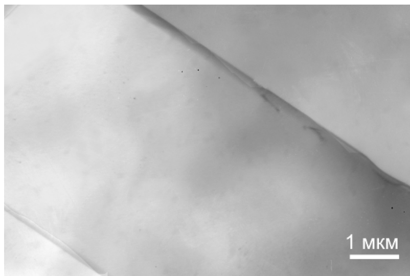
Рис. 2.1. Вихідна структура сталі SS316 після термічної обробки при 1340 К/0,5 год.
