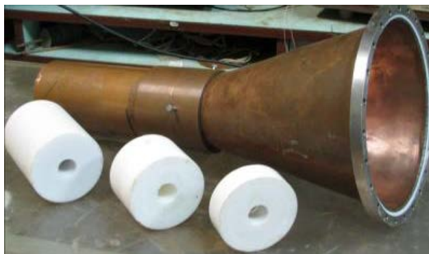
Рис. 3.6. Елементи хвильоводно-діелектричної структури: діелектричні вставки довжиною L = 0,25\lambda , 0,5\lambda , 1,0\lambda і додатковий хвильовід з розтрубом.
