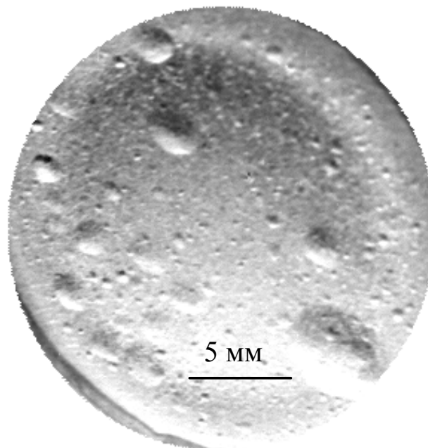
Рис. 3.7. Характерний вид поверхні сталі з переважно феритною структурою після опромінення дозою 1 \cdot 10^{25} \text{ H}_2^+/\text{м}^2 .
