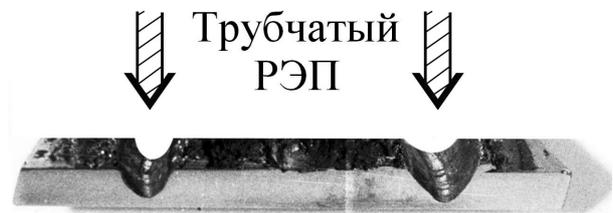
*Рис. 1. Фрагмент облученной мишени из сплава 12Х18Н10Т*
