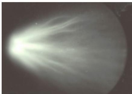
Рис.4. Изображение тлеющего высоковольтного разряда при атмосферном давлении
