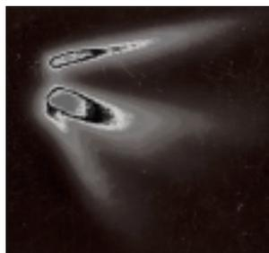
Если вершину конуса у острейшего активного электрода скруглить механически или дать ему поработать некоторое время в искровом режиме, то происходит изменение в структуре короны. При этом увеличивается количество токовых трубок и корона становится ветвящейся (рис.3). При
