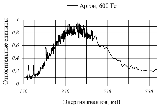
Рис.4. Спектр рентгеновского излучения в аргонной плазме. Начальное давление \sim 8.5 \cdot 10^{-5} Торр, ток пучка \sim 0.75 А, энергия электронов пучка 3 кэВ, магнитная индукция H=600 Гс
