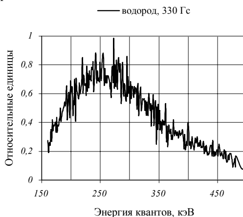
Рис.2. Спектр рентгеновского излучения в водородной плазме. Начальное давление \sim 8.5 \cdot 10^{-5} Торр, ток пучка \sim 0.75 А, энергия электронов пучка 3 кэВ, магнитная индукция H=330 Гс
