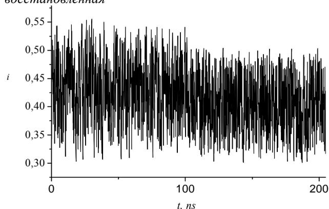
Рис. 7. Часть модулированной бинарным сигналом (Рис.2) хаотической последовательности.
