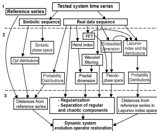
Рис. 1 Структура и связи алгоритмов составляющих основу набора программ **ATDP Suite**. Разделы 1, 2, и 3 соответствуют - подготовке данных, обра-
