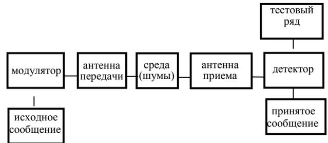
Рис. 5. Схема канала хаотической связи
